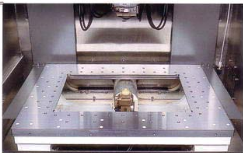
具有铸件结构支撑的4边工作台
