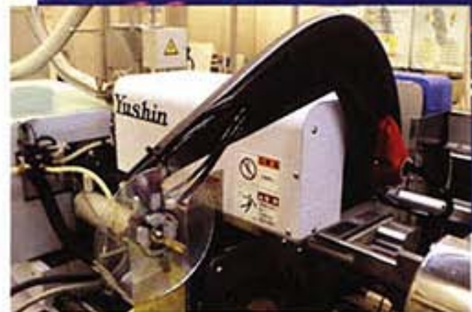
高速取出機 High speed take-out robot
